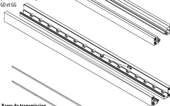
Barre de transmission du moteur
